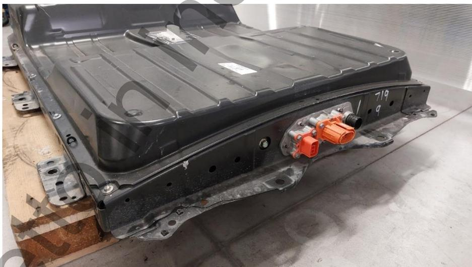
Figura 7 – Batteria di trazione con involucro in metallo
