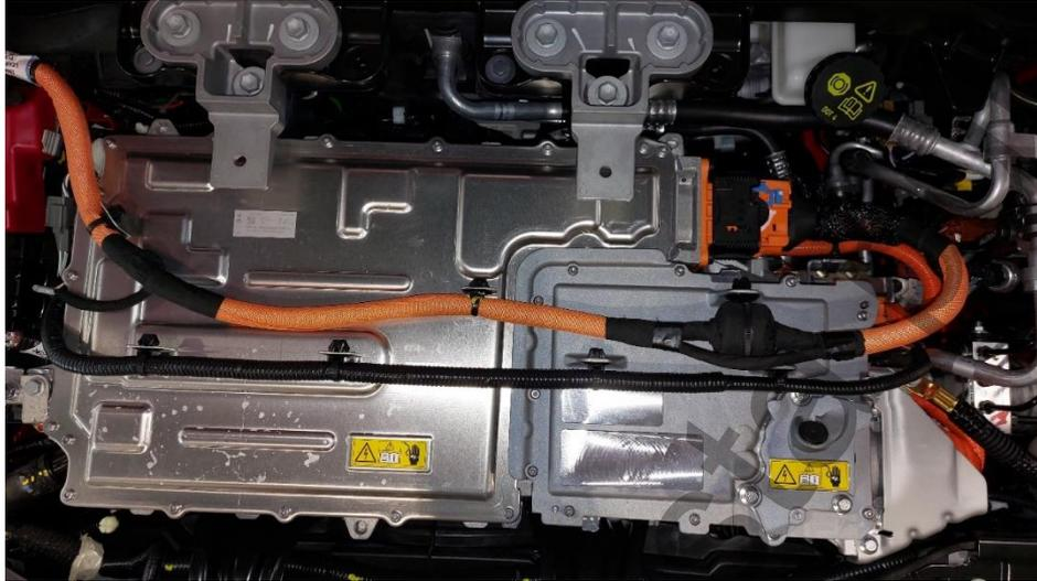
**Figura 3 – Esempio di cablaggio elettrico di alta tensione correttamente isolato**
