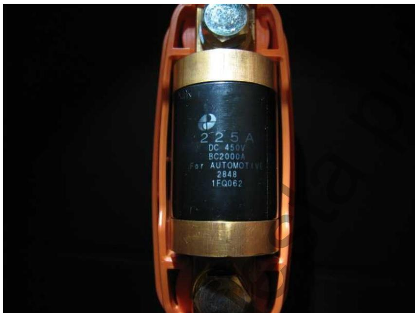
**Figura 13 – Fusibile presente all'interno della batteria di alta tensione di veicoli ibridi e/o elettrici**
