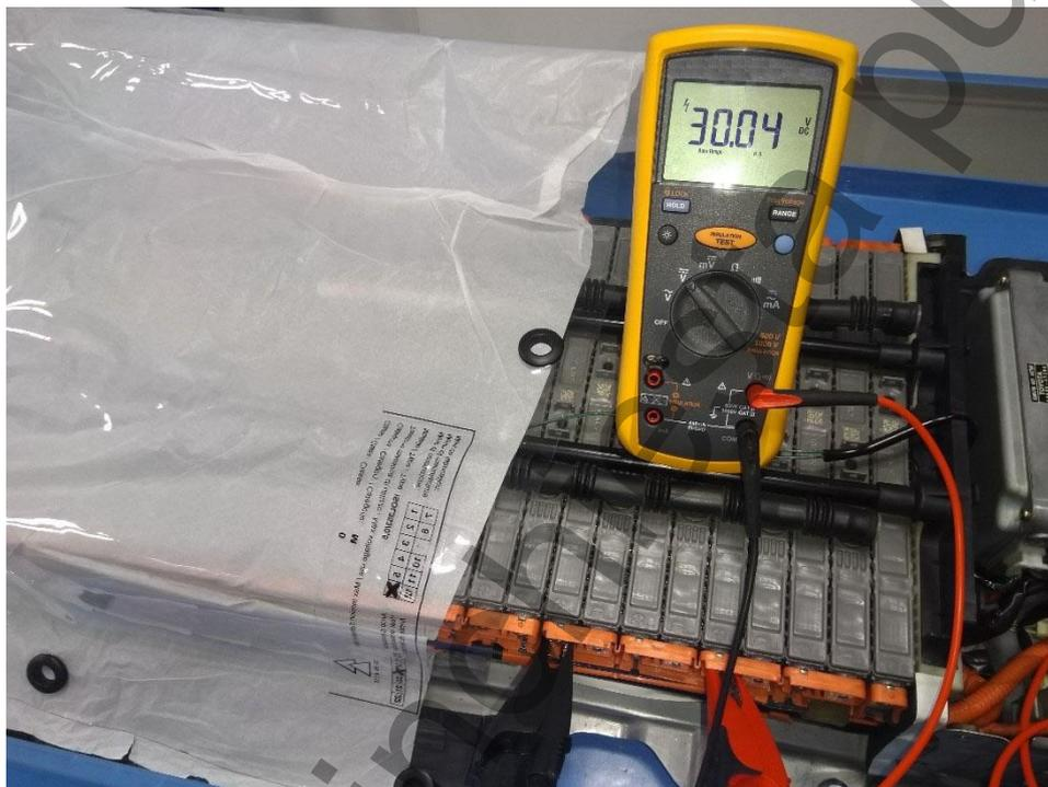
**Figura 19 – Esempio di misura elettrica effettuata sulla batteria di trazione di un veicolo ibrido**
