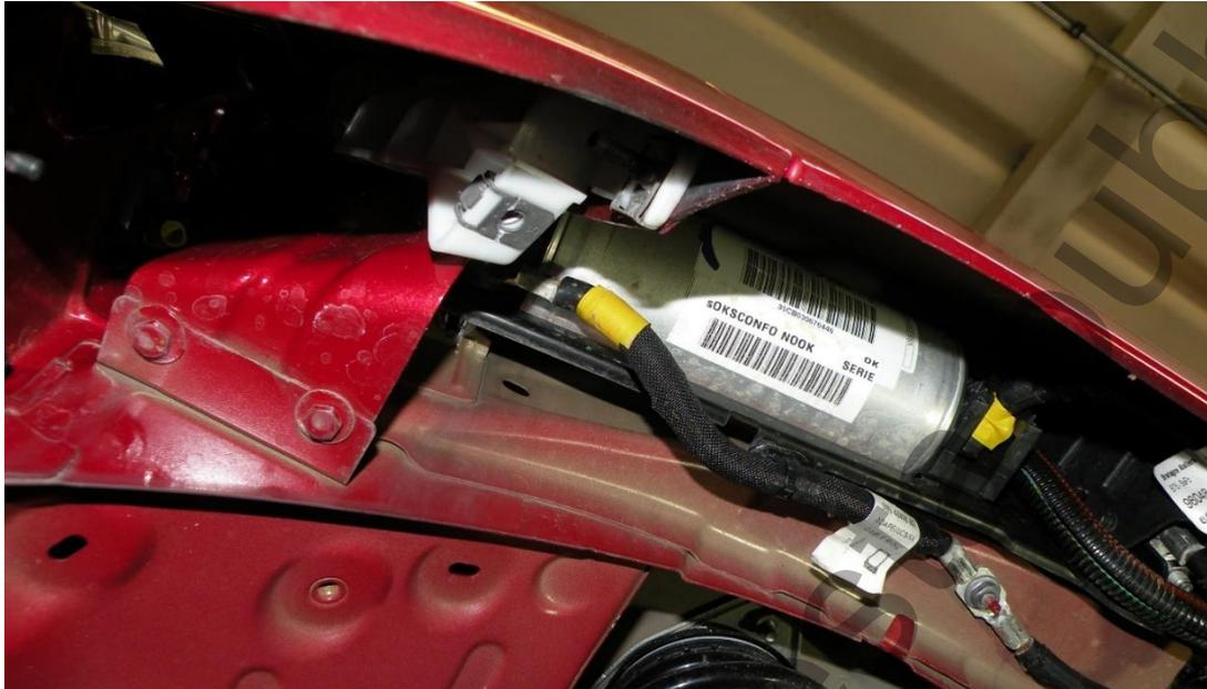
Figura 15 – Esempio di supercondensatore [Fonte: VEI 114-03-03 modificato]
